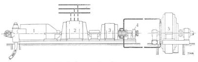
Abb. 13. Schema des Turbo-Fördersystems. 1 Dampfturbine; 2 Drehstromgenerator; 3 Steuerdynamo; 4 Erregermaschine zu 2; 5 Fördermotor.
