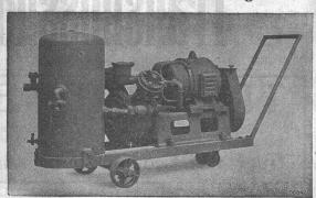
LEICHTE BAUART OHNE KÜNSTLICHE KÜHLUNG, MOTOR-ANTRIEB MIT JEDER STROMART, ALLEN SPANNUNGEN UND PERIODEN-ZAHLEN.
