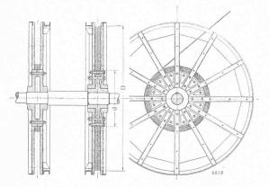
Abb. 6. Bobinen für Flachseile.
