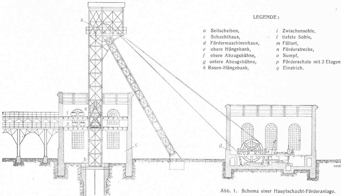
Abb. 1. Schema einer Hauptschacht-Förderanlage.
