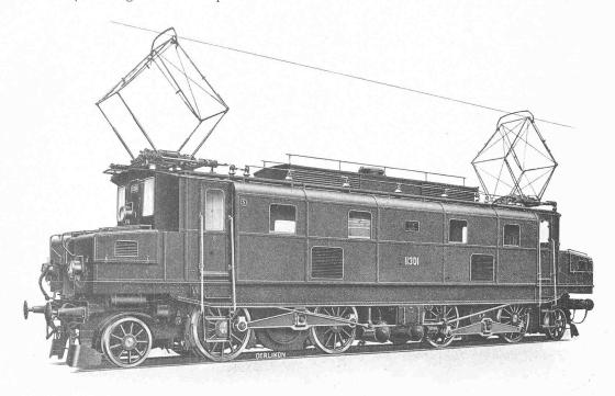
Abb. 1. Wechselstrom-Schnellzuglokomotive von 2250 PS Normalleistung für die Gotthardlinie der Schweiz. Bundesbahnen.
