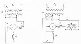
Abb. 6 und 7. Schaltung der Moloren für Fahrt und für Bremsung.
