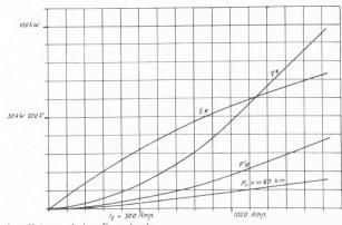
Abb. 8 und 9. Charakteristische Kurven eines Motors und einer Drosselspule.
