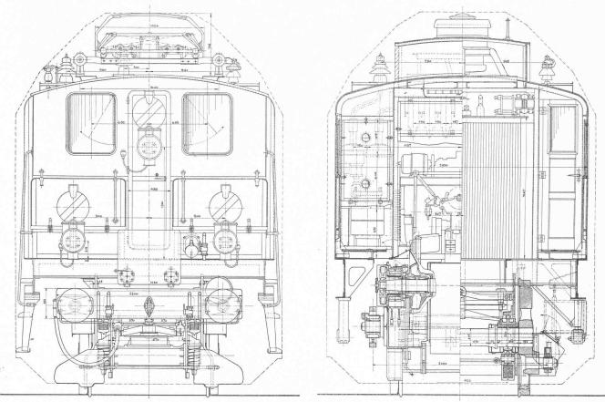
Abb. 4 und 5. Stirnansicht und Querschnitte durch Antriebritzel und Triebrad. — Masstab 1:35.
