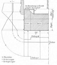
Abb. 14. Diagramm der Dehnungsmessungen. Ordinaten-Masstab 0,5 cm = 0,001 mm.
