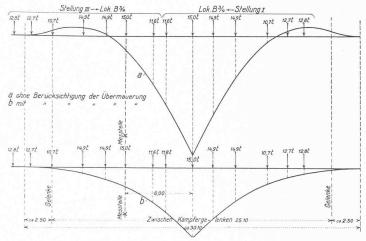
Abb. 13. Einflusslinien der Scheitelsenkung für Belastungsfälle I und II, oben ohne, darunter mit Berücksichtigung der Uebermauerung. Für eine Einzellast  $P=1\ t$  und eine Elastizitätszifter  $E=1\ t/m^2$ , entspricht  $^{1}$ <sub>3</sub> mm der Ordinaten der Einflusslinien I m Scheitelsenkung.
