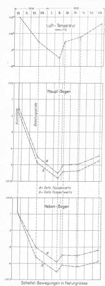
Abb. 12. Lufttemperatur-Kurve (oben) und Diagramme der Scheitelbewegungen in der Zeit vom September 1918 bis Juli 1919. (Zeitmasstab 5 mm = 1 Monat.)
