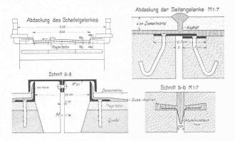
Abb. 7. Einzelheiten der Fugen-Abdeckung, 1:140, 1:14, 1:7.
