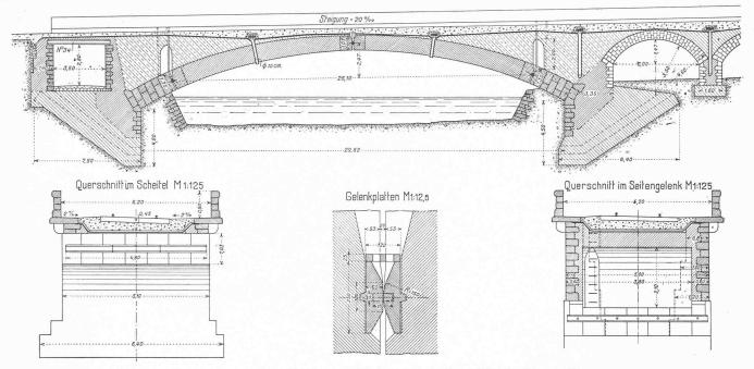
Abb. 6. Längsschnitt des Hauptbogens 1:250, Querschnitte 1:125 und Gelenk-Ausbildung 1:12,5.
