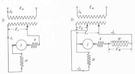
Abb. 6 und 7. Schaltung der Moloren für Fahrt und für Bremsung. Tr Transformator; I Motor-Rotor; II Kompensations- und Hilfspol-Wicklung; III Magnetwicklung; IV Drosselspule.
