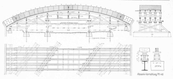
Abb. 8. Lehrgerüst samt Betonierungs-Lamellen des Hauptbogens. - Masstab 1:200.
