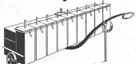
für stündliche Gasleistungen bis zu 50 000 Kubikmeter z. Autogenschweissen im Hoch- und Tiefbau, Eisenbahn- und Brückenbau, Werften, Thermogenarbeiten, Beleuchtungs- und Scheinwerferanlagen usw., nach den Patenten
