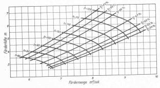
Abb. 32. Charakteristik der Pumpe für 8000 l/sek Förderleistung.
