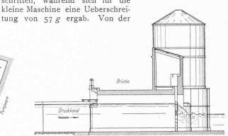
Abb. 30. Querschnitt durch Ueberfallbrücke. - 1:300.
