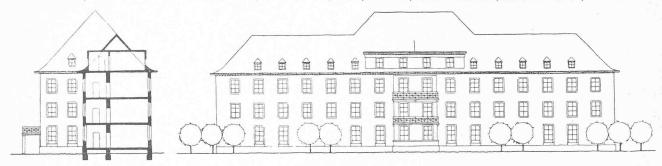
· Abteilungen und eine zentrale Lage des Operationsaales ermöglichen. Platzverschwendung für Garderoben zu rügen. Treppenausgänge auf den Etagen unzweckmässig, eingeschlossene dunkle Korridore vor den Einzelzimmern. Verfehlte und zu kleine Liftanlage. Teeküchen zu gross und zu abgelegen. Septisches Operations-Zimmer zu gross. Fassaden unruhig. Kubikinhalt mit 18292 m³ über Bedürfnis gross.
