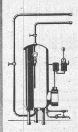
Elektrischer Fabrik - Heizapparat
