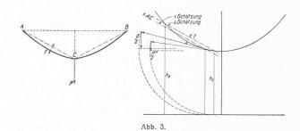
Beispiel. Für ein auf eine bestimmte Strecke AB gespanntes Seil, das in der Mitte ein Gewicht P trägt, sei der zulässige Durchhang, der Punkt C, festgelegt (Abbildung 3). Welches sind nun für ein bestimmtes Seil die maximale Spannung aus Eigengewicht und Last und welches die Abweichung f von der Visierlinie AC?
