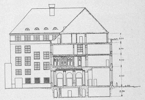
Querschnitt durch den Mittelbau (Schalterhalle). - Masstab 1:350.
