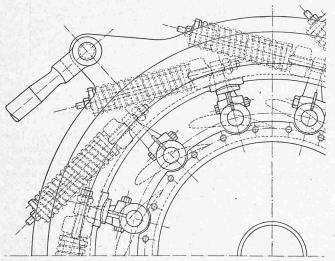
Abb. 22. Antrieb der Drehschaufeln. - Masstab 1:12,5.
