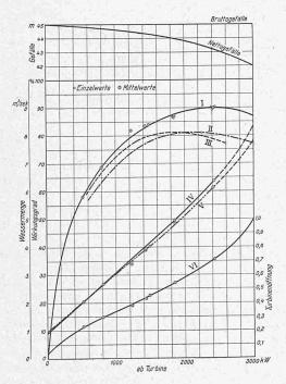
Abb. 30. Charakteristische Kurven der Turbine.
