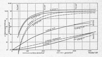
Abb. 31. Wirkungsgrad  $\eta$  und Spannungserhöhung  $\varepsilon$  der Generatoren.
