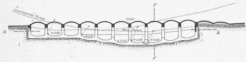
Abb. 7. Vertikal-Schnitt E-E durch das Sammelbecken des Kraftwerks Massaboden. - 1:300.
