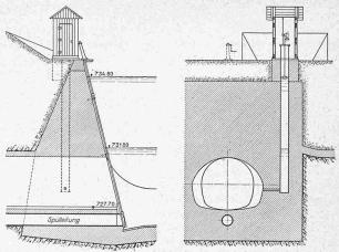
Abb. 10. Einlaufbauwerk zum Stollen. - Masstab 1: 200,
