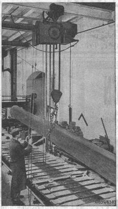
Elektroflaschenzug von 4000 kg Tragfähigkeit, mit Unterflanschlaufkatze.
