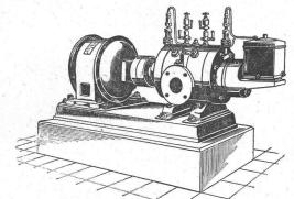
Direkte Kupplung mit Elektromotoren oder Riemenbetrieb. Ruhiger Gang, Luftförderung ohne Stösse. Keine Ventile oder andere Steuerorgane.
