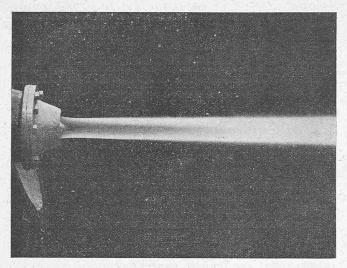
Abb. 2. Zylindrischer Wasserstrahl bei axialer Lage der Lenkplatten.
