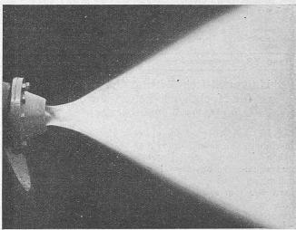
Abb. 3. Hohlkegelförmiger Wasserstrahl bei verdrehter Lage der Lenkplatten.
