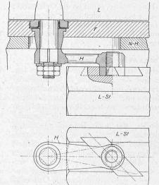
Abb. 7. Detail des Lenkplatten-Antriebes.
