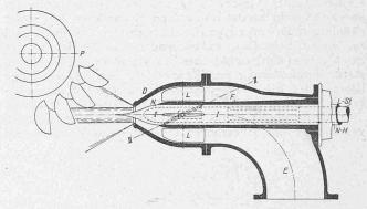
Abb. 1. Schema der Lenkplatten-Regulierung System Seewer.
