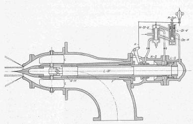
Abb. 8. Universal-Regulierung System Seewer für Hochdruck-Pelton-Turbinen. Längsschnitt durch die Düse und die Servomotoren.
