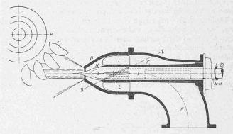
Abb. 1. Schema der Lenkplatten-Regulierung System Seewer.
