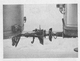
Abb. 6. Verbindung von automatischer und gewöhnlicher Kupplung.
