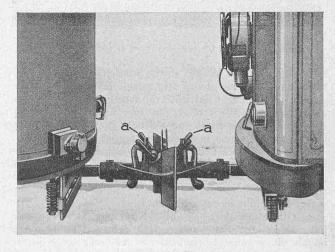
Abb. 3. Kupplung gelöst (Stellung IV in Abb. 4).
