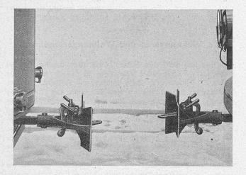
Abb. 1. Zwei Wagen, zum automatischen Kuppeln bereit.
