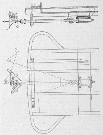
Abb. 5. Einbau der Kupplung am Strassenbahnwagen. - 1:20.
