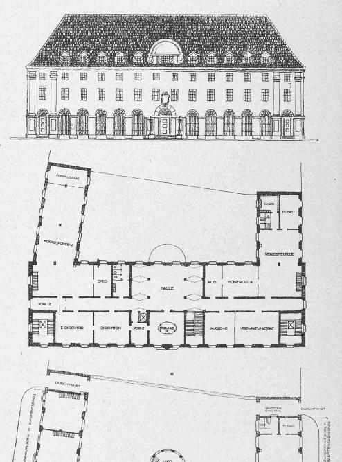
I. Preis. Entwurf Nr. 5. — Arch. F. & S. Saager in Biel. — Erdgeschoss, I. Stock und Fassade. — 1:500.
