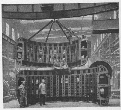
Abb. 3. Einphasen-Wechselstrom-Generator von 9000 kVA für das Kraftwerk Ritom. Ansicht der zum Blechen bereiten Statorhälften. - Brown, Boveri & Cie., Baden.
