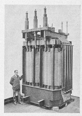
Abb. 7. Einphasen-Wechselstrom-Transformator für das Kraftwerk Ritom ohne seinen Oelkessel, gebaut von der Maschinenfabrik Oerlikon.
