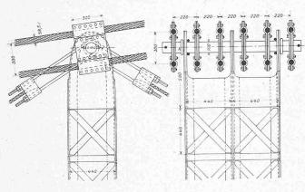
Abb. 4. Details eines Fachwerkpfostens der Schwebefähre in Bordeaux. Masstab 1:30.
