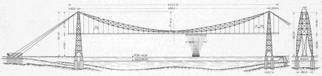
Abb. 1. Schwebefähre über die Garonne in Bordeaux nach dem System Leinekugel le Cocq. - Längs- und Seitenansicht. - Masstab 1:3500.
