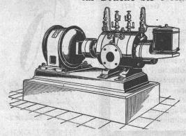
Direkte Kupplung mit Elektromotoren oder Riemenbetrieb. Ruhiger Gang, Luftförderung ohne Stösse. Keine Ventile oder andere Steuerorgane. Geringe Abnützung infolge der patentiert. Entlastungsringe
