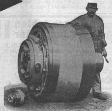
Benn Kupplung Nr. 12 für 600 PS gellefert in eine Zementfaprik,
