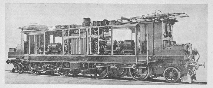
Abb. 2. Elektrische Probe-Schnellzuglokomotive 1B+B1 von 2250 PS Normalleistung für die Gotthardlinie der S. B.B. (Text hierzu auf S. 152).
