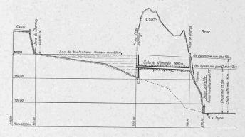
Abb. 2. Längenprofil zum Kraftwerk Broc. - 1:75 000 / 1:5000.
