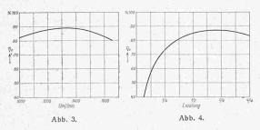
Die Wirkungsgrade dieser neuen Turbine scheinen dank der einfachen, guten Wasserführung recht hohe zu sein. Prof. Bänki fand mit einer sehr kleinen Ausführung von 135 mm Durchmesser im Maschinen-Laboratorium der Techn. Hochschule in Budapest Wirkungsgrade bis zu 89  $^{0}/_{0}$  (Abb. 3). Bei einer grösseren Ausführung mit regulierbarem Leitapparat ergaben sich Wirkungsgrade nach Abb. 4.
