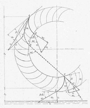
Abb. 2. Geschwindigkeits-Diagramme der Bánki-Turbine.
