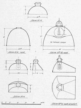
Abb. 1. Schirm-Typen der Eidg. Baudirektion.
