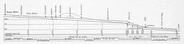
Abb. 9. Längsprofil zum Projekt der Sihlverlegung von Ing. H. Sommer. — Längen 1:40 000, Höhen 1:2000.
