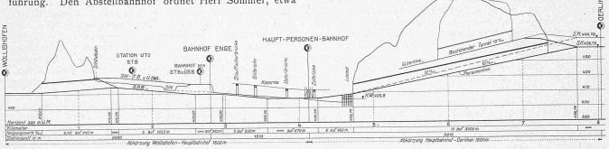
Abb. 10. Längsprofil der Bahnstrecke Wollishofen-Zürich-Oerlikon laut Projekt H. Sommer. - Längen 1:40 000, Hönen 1:2000.
