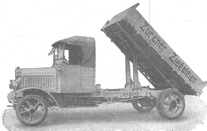
5 Tonnen Cardanwagen mit vom Motor aus automatisch kipparer Ladebrücke.
