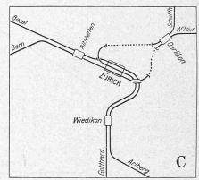
Abb. 4 bis 6. Typische Möglichkeiten kreuzungsfreier Linienführung in einem Durchgangsbahnhof für Zürich.
