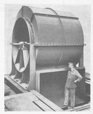
Abb. 10. Oerlikon-Ventilator mit 378 PS Kraftbedarf.
