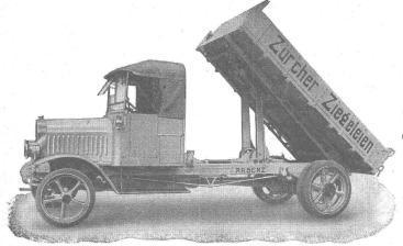
5 Tonnen Cardanwagen mit vom Motor aus automatisch kippbarer Ladebrücke
