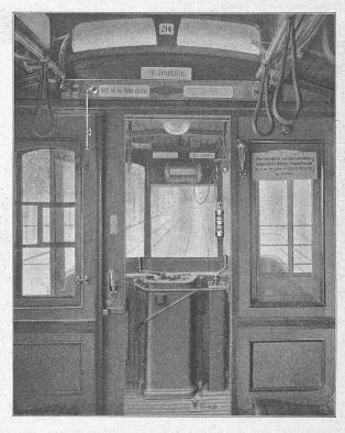
Abb. 5. Signal-Lampen beim Führerstand (über der Handbremskurbel).
