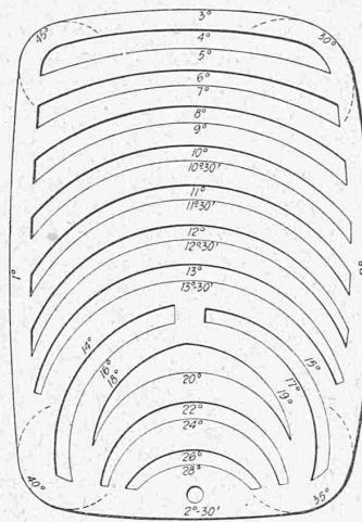
zu bestimmen. Der mit  $1^{\circ}$  bezeichneten Kurve grössten Halbmessers entspricht somit ein Radius von  $1745,71 m$ , der mit  $45^{\circ}$  bezeichneten kleinsten Halbmessers ein solcher von  $39,79 m$ . Im gebräuchlichen Maßstab  $1:1000$  würde das Plättchen bei Beibehaltung der nebenstehenden Anordnung etwa  $44 cm$  hoch und  $31 cm$  breit werden.
