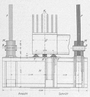
Abb. 2. Neue Lagerung des Ueberbaues auf der Hubvorrichtung.
