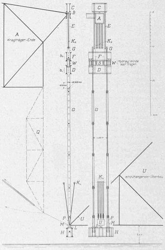
Abb. 1. Schematische Darstellung der frühern Aufzugvorrichtung. - 1:500
