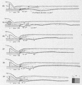
Abb. 8. VII. Versuchsreihe. Einfluss der Flossfeder-Längen (laut den jeweils eingeschriebenen Massangaben) auf das Kolken bei Ueberfall von:
