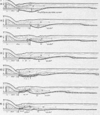
Abb. 4. II. Versuchsreihe. Kolkbildung bei Ueberfall von 100 *tlsek* auf: Nr. 8 kurze Schwelle; Nr. 9 lange Schwelle; Nr. 10 desgl. mit Vorsperre; Nr. 11 kurze Schwelle mit anschliessendem, durchbrochenem Schwellenboden; Nr. 12 Desgl. mit Verlängerung durch Block-Vorlage; Nr. 13 u. 14 Desgl. mit beweglicher Flossfeder, geschlossen (Nr. 13) und teilweise durchbrochen (Nr. 14).
