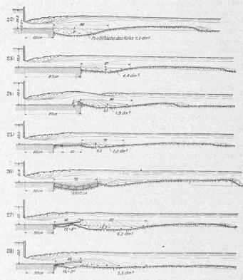
Abb. 6. IV. Versuchsreihe: Unterströmen von 100 l/sek.
