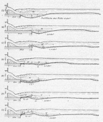
Abb. 5. III. Versuchsreihe: Zwischendurchströmen von 100 l/sek.
