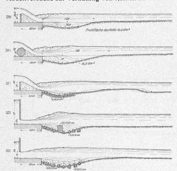
Abb. 7. V. Versuchsreihe (Nr. 29 und 30) Ueberfall über scharfe Kante und über Walzenwehr auf eine kurze Schwelle. VI. Versuchsreihe (Nr. 31 bis 33) Kurze Schwelle mit unregelmässigen Block-Vorlagen: Nr. 31 Ueberfallen von 100 l/sek; Nr. 32 Unterströmen von 200 l/sek und Nr. 33 Unterströmen von 230 l/sek.
