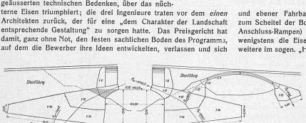
Abb. 2. Entwurf Nr. 14, III. Preis. - Hauptverhältnisse der Widerlager, Masstab 1:500.
