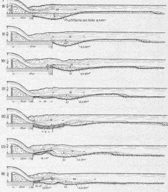
Abb. 4. II. Versuchsreihe. Kolkbildung bei Ueberfall von 100 *l/sek* auf: Nr. 8 kurze Schwelle; Nr. 9 lange Schwelle; Nr. 10 desgl. mit Vorsperre; Nr. 11 kurze Schwelle mit anschliessendem, durchbrochenem Schwellenboden; Nr. 12 Desgl. mit Verlängerung durch Block-Vorlage; Nr. 13 u. 14 Desgl. mit beweglicher Plossfeder, geschlossen (Nr. 13) und teilweise durchbrochen (Nr. 14).
