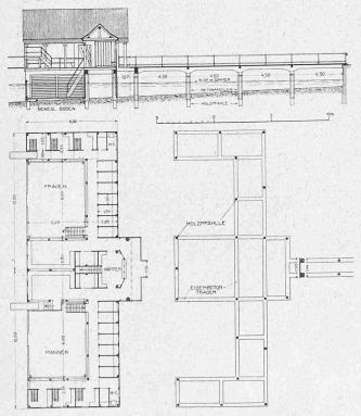
Abb. 1 bis 3. Schnitt und Grundrisse zur Badanstalt Oberrieden. - 1:300.
