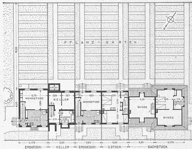
Abb. 16. Grundrisse einer Sechshäusergruppe. — Masstab 1:400.
