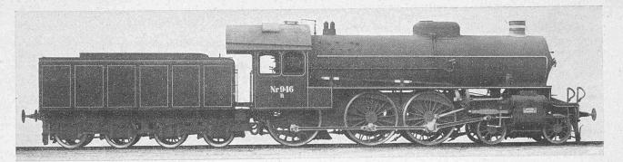
Abb. 2. 3/5 gekuppelte Heissdampf-Schnellzuglokomotive, Klasse F, der Dänischen Staatsbahn.
