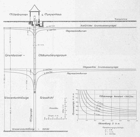
Abb. 3. Schnitt durch eine Filterbrunnen-Anlage mit Darstellung der Depressionskurven. Im Diagramm rechts: Beziehung zwischen Absenkung und Brunnentiefe für verschiedene Durchlässigkeitsgrade.
