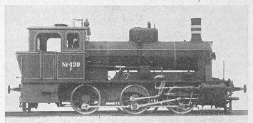
Abb. 1. Dänische 3/3 gekuppelte Heissdampf-Tenderlokomotive, Klasse F.
