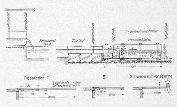
Abb. 1. Anordnung des Versuchs-Gerinnes. Oben Längsschnitt 1:150.
