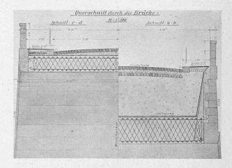
Nr. 25. Motto "Sichelbogen". Gut studiertes Projekt. In ästhetischer Beziehung wirkt der Sichelbogen etwas schwer. Der Stabbogen ist als leichtere Konstruktion vorzuziehen. Sein Gewicht beträgt nur rund 175 t gegenüber 245 t für das vorliegende Projekt.
