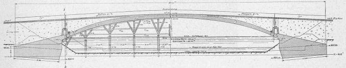
Entwurf Nr. 21, Projekt II: Dreigelenkbogen. Längsschnitt 1:500 und Detail-Schnitte 1:125 und 1:50.
