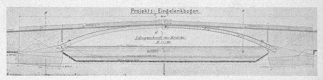
Entwurf Nr. 21, Projekt 1: Eingelenkbogen. - Längsschnitt 1:500 und Querschnitte 1:100.
