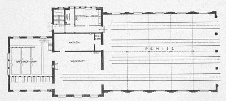
Abb. 20 und 21. Grundriss und Längsschnitt der Depotanlage Täuffelen. — 1:400.
