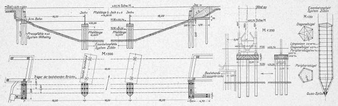
Abb. 13. Fundation der Brücke über den Aarekanal bei Nidau 1:500 und 1:250; Eisenbetonpfahl System Züblin 1:50.
