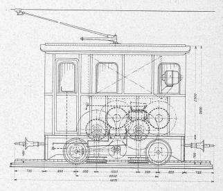
Abb. 11. Zweimotoren-Lokomotive, Typenskizze 1:60
