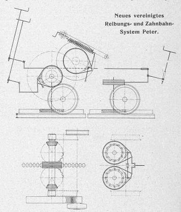
Abb. 9. Antrieb- und Bremsschema eines Motorwagens.
