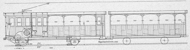
Abb. 8. Triebwagen-Zug für Zahnbahn nach System Peter. - Typenskizze 1:100.
