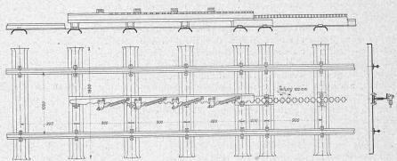
Abb. 6. Zahnstangen-Einfahrt. - Masstab 1:50.
