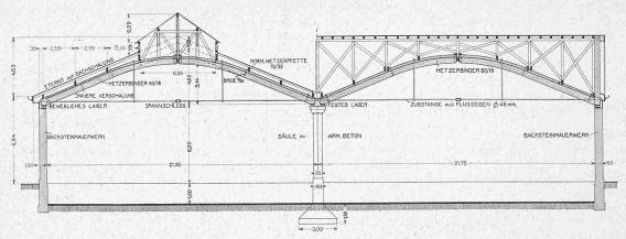
Abb. 8. Querschnitt durch Hallenmitte (links) und durch eine Querfirst (rechts). - Masstab 1:300.
