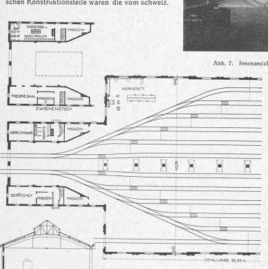
Abb. 5. Grundrisse und halber Querschnitt. - Masstab 1:600.
