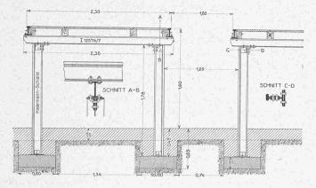
Abb. 6. Einzelheiten der Putzgruben-Konstruktion. - 1:50.
