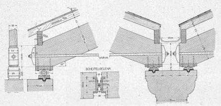
Abb. 9. Einzelheiten der Binder-Auflager und des Scheitelgelenkes. - 1:40.
