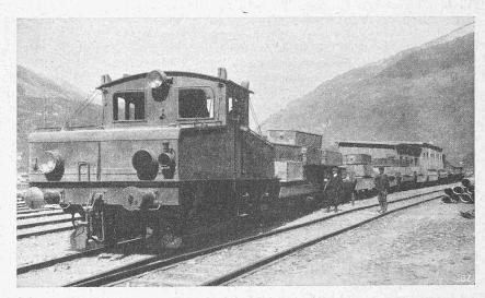
Abb. 23. Akkumulatoren-Lokomotive der A. E. G. mit Materialzug, vor der Einfahrt. Die Normalspurzüge werden tunneleinwärts geschoben und tunnelauswärts gezogen.
