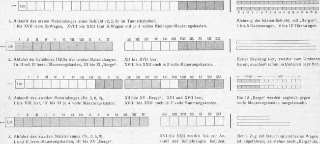
Abb. 34. Schema des Umladens im Tunnelbahnhof { Links Normalspur, Rechts Kleinspur.
